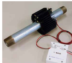
「フレキナー®」によるIoT用自立電源システム
