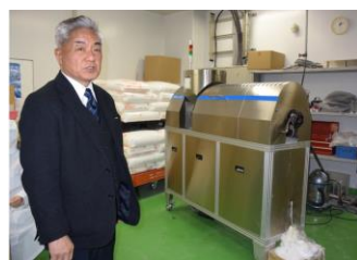
直径500±300nmのナノファイバーの量産を可能にした「量産型ナノファイバー溶融紡糸装置」の特徴を説明する近藤氏
