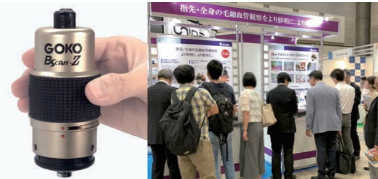
(写真左)体表面の毛細血管血流映像を高倍率で簡単、鮮明に観察できる「GOKO Bscan-Z」。自社開発の流速計測ソフトウェア「GOKO-VIP」も2019年に発売。(写真右)健康分野で国内最大のビジネスショー「健康博覧会2019（第37回）」に出展した際のブースの様子。海外からの来客も多く、国内のみならず海外への販売にもつながっている。(2019年01月23日～25日、東京ビッグサイト)
