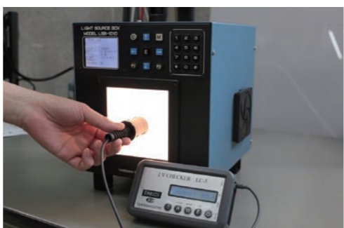
EMIN社を通じて問い合わせがあった、発光面内の明るさを保証した面光源装置と発光面の明るさを測定する輝度計
