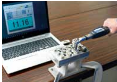
ボルトを締め付け、パソコンのソフトで ピークトルク値を受信している様子
