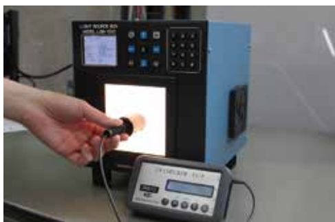
EMIN社を通じて問い合わせがあった、発光面内の明るさなどを保証した面光源装置と発光面の明るさを測定する輝度計
