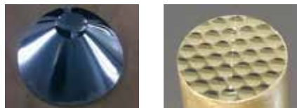
非球面フレネルレンズ加工サンプル（左） マイクロレンズアレイ加工サンプル（右）
