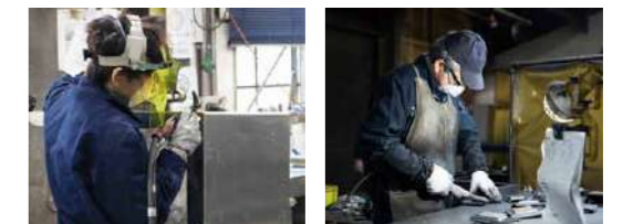
■ 溶接工程の様子(左: Tig溶接、右: スパッタ除去)
