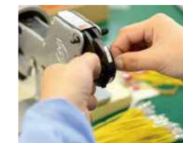
端子圧着の様子
