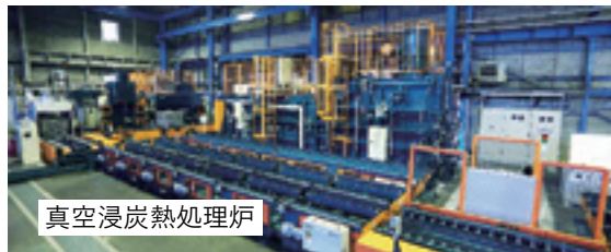
【新たに導入された真空浸炭熱処理炉】
