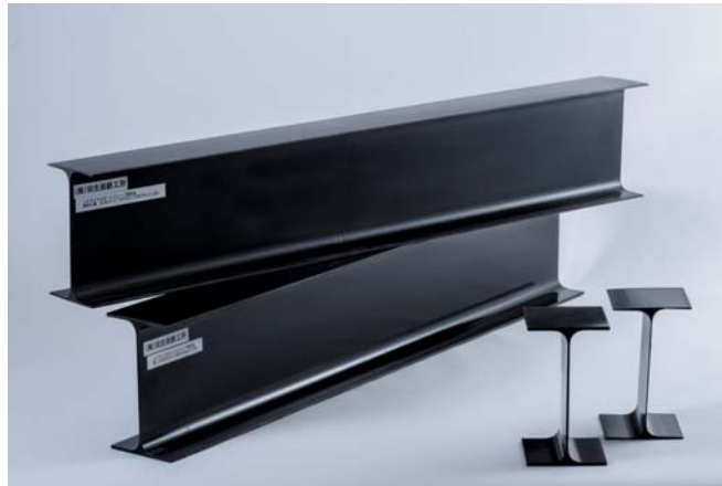
オートクレーブ装置で成形した CFRP
