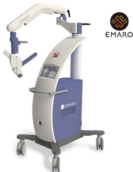
空気圧駆動型 内視鏡ホルダロボット EMARO
