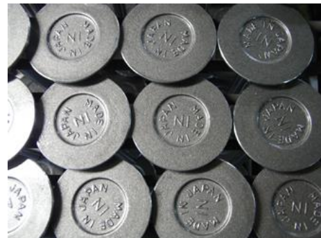
同社が製造したエンジンバルブ
