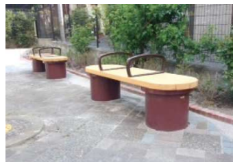
防災時に「かまど」として使用できるベンチ
