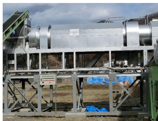
補助金を活用して設置した「骨材乾燥用機械：ホットドライヤー」
