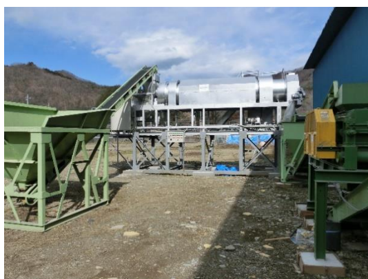
補助金を活用して設置した「骨材乾燥用機械：ホットドライヤー」
