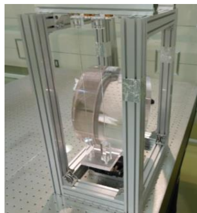
図10 サファイアミラー (サファイアパーツで懸架したところ)
