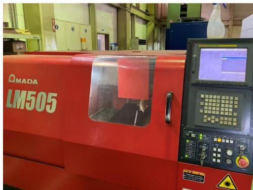
高精度微細加工レーザー機
