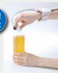
モノの柔らかさを物理量で 数値化、指に装着して 計測・作業比較評価などの 新しい計測技術
