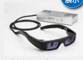
網膜走査型レーザアイウェア 視力やピント位置の影響を受け にくい投影方式
