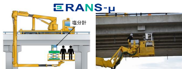
橋梁点検車に搭載可能な中性子塩分計RANS- \mu
