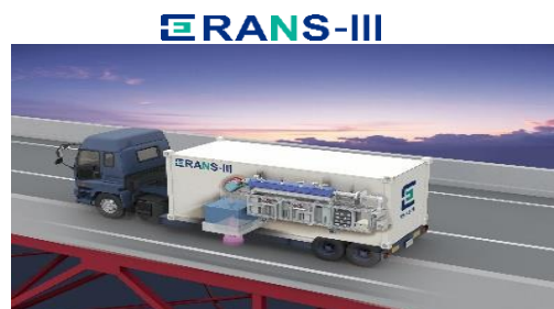
車載型小型加速器中性子源RANS-III
