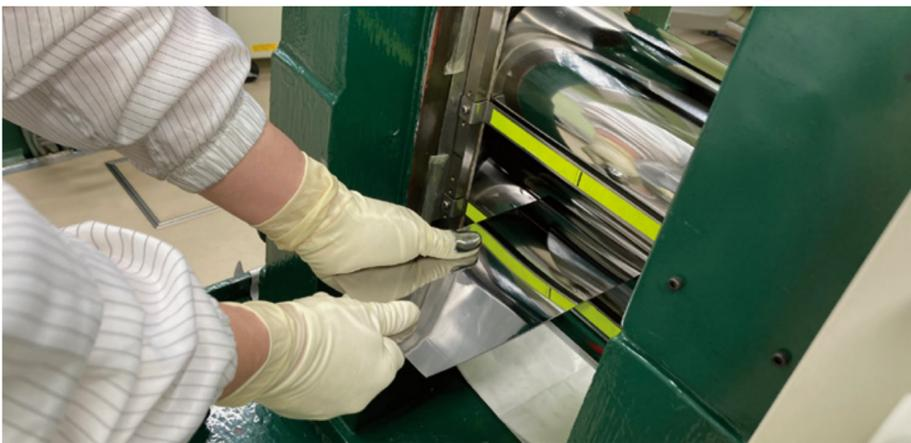
当社の冷間圧延は2名ペアで行います。写真の入れ手が箔を上下ロールにはさみ入れ、受け手が箔を受け、厚さ評価やロール隙間の調節を行います。この阿吽の呼吸が重要で、高品質の極薄箔が製造されます。
