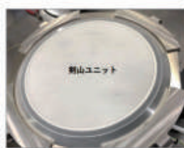
ウエハリング供給対応の「剣山」ユニットと剣山部分の拡大
