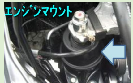
振動抑制連結部品のエンジンマウント
