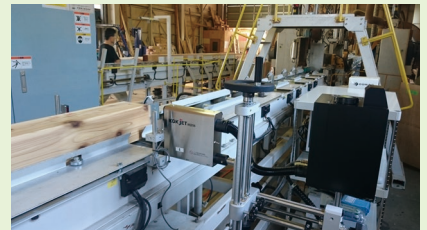
製造ラインで直接木肌に印字する横噴き出シインクジェットプリンターにより生産性アップ
