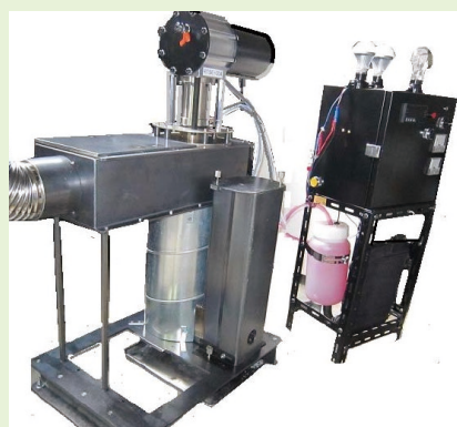
スターリングエンジンを使った、ロケットストーブ発電
