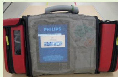
電磁波シールド材は、電磁波を遮断しながら、シールド内部を透かして見える
