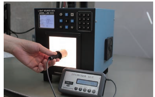
EMIN社を通じて問い合わせがあった、発光面内の明るさなどを保証した面光源装置と発光面の明るさを測定する輝度計
