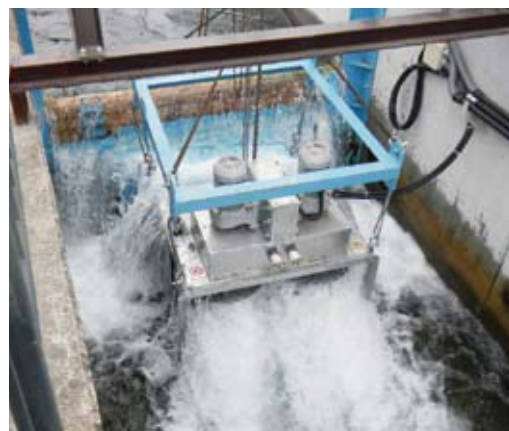
落差 3m 以下の流水で、40kw 以下の発電が可能
