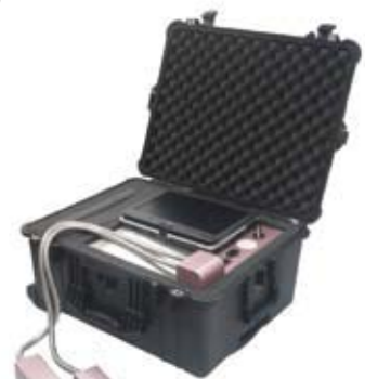
光パルスエコー法による可搬型非破壊検査装置
