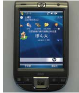
打撃音樹内腐朽簡易診断装置「ぼん太」
