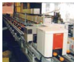
光センサー撰果(みかんの糖度・酸度を自動測定) (有限会社御浜柑橘)
