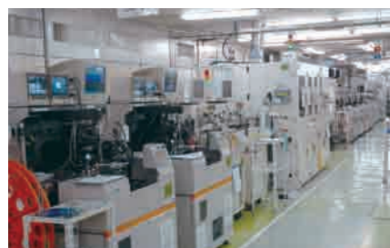
生産性を高めるための設備。ベルト状になったリードフレームが、3台の生産設備を通過していく
