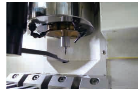
微細穴加工を行う精密加工機。ここに試行錯誤を繰り返して完成した、森川製作所の技術が詰まっている
