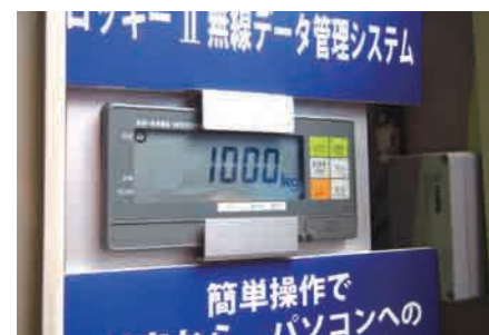
「ロッキーII」のモニター。計測データは印字するだけでなく、パソコンへ転送することも可能
