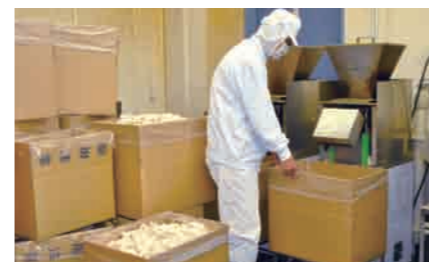
しらすを配合した八穀米を膨化発泡食品製造機に投入。一度に6枚ずつ膨化発泡され出てくる
