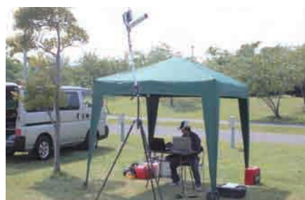
飛行中のUAVをGPSで監視するコントロール基地
