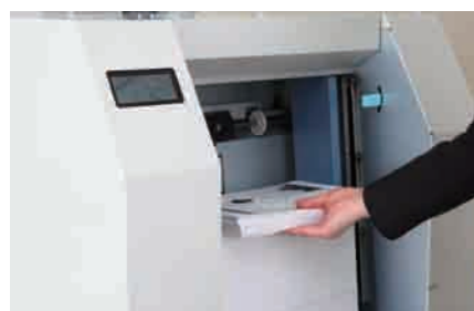
給紙台に使用済みの用紙をのせるだけで1時間後には再生紙ができあがる
