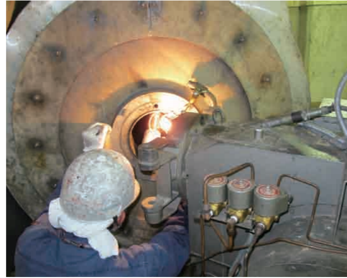
「テックコート」を塗っていく作業員。作業時間は、調整も含めて2時間～半日程度 未来の技術に注目が集まる中、既存の設備に対する技術は特徴的
