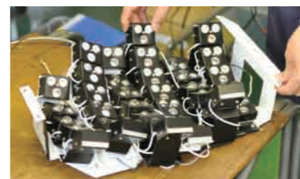
LEDチップの付いたブロックの角度を微妙に変えて1列ごとに調整。完成された形は芸術作品のよう
