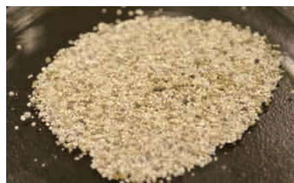
「I.C.」の中身「インテシウム」。石灰が外装フィルムを突き破らないよう、できるだけ粒子を細かくするなど細部にわたり安全性にこだわった
