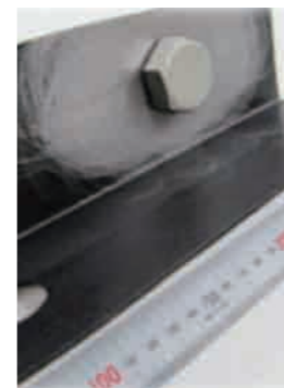
「クーレーザー」で塗膜除去された鉄鋼素材の見本。水などがたまりやすく、塗料の劣化や錆が発生しやすいボルト周囲の塗装もきれいに除去されていることが分かる。
