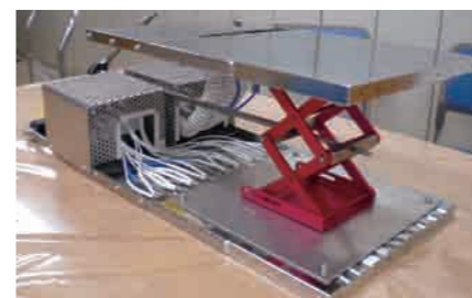
ヒーター台がジャッキで上下する「予熱くん」。上下の金型を同時に熱したいという顧客の要望に応じて作られたオーダーメイド商品
