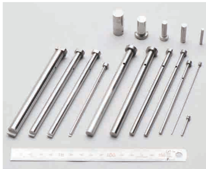
使用する樹脂の流動性に合わせ、穴の幅を0.005～0.05ミリの幅で選べるようバリエーションを揃えた「ガストース」
