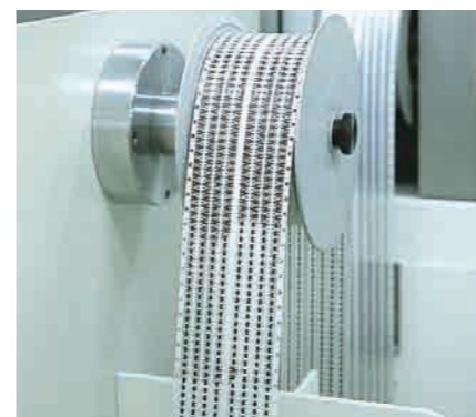
ひとつのリードフレームに、最大20列まで部品を並べることができ、全列の品質を均等に保つ
