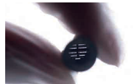
ピンの内部は空洞。先端にガスを逃がす穴をあけた画期的な形状
