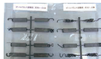
「ガストース」を使用した実験加工品(左)と、使用していないもの(右)。使用していないものでは、樹脂の流動性が悪く、正しく成形できないものが多い
