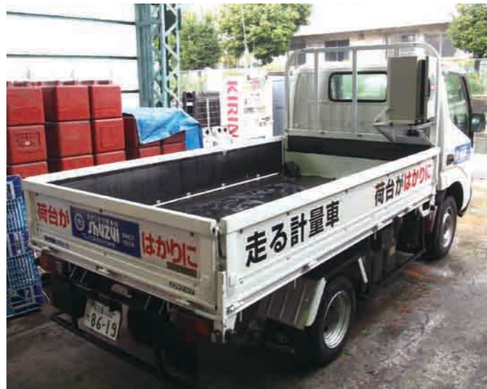
「ロッキーII」を搭載したトラック。荷台の下4カ所には、特殊ロードセルを設置。荷台に荷物を乗せるだけで、その重さを正確に計量することができる。
