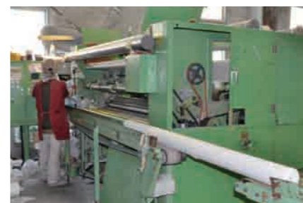
原紙を紙管に巻き付け必要な長さ巻き取る。業界トップクラスの高品質な商品が出来上がる
