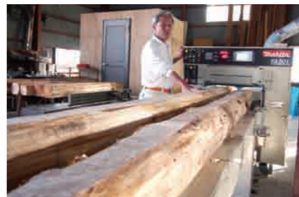
製造作業中の横内社長。ヒノキを削るスピードで仕上がりが変わるため、その目は真剣だ
