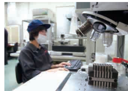
試作品ができるたびに、顕微鏡でバリの有無を確認。これを繰り返し「バリレス」へと近づけていく
