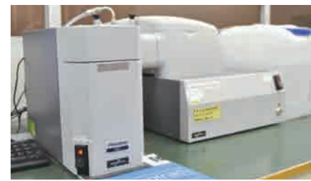
社内で徹底した製品の品質管理を行うため、助成金で粒度分布測定機や、その他の分析装置を購入した
