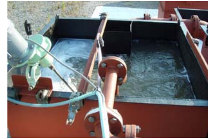
希硫酸中和方式装置の攪拌試験
