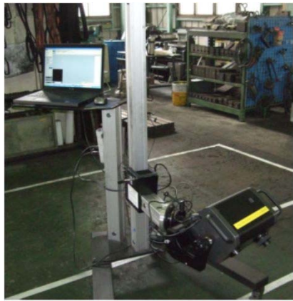
井上製作所が導入した3次元スキャナ「デジタイザ」
