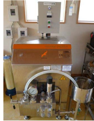
「エクセルキトサン」を界面活性剤として用いるために必要な高圧ホモジナイザー
