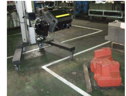
デジタイザを使用した金型部品の計測風景 業の製造現場のあるべき姿を語っている。
