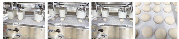
■スマート化診断後の設備改善の検討 新丸め機導入により、生地が丸めのためにわき道にそれずに、ストレートに下流に流されていく。丸めおしの必要もなくなるので、1名分の省力化が可能になる。
