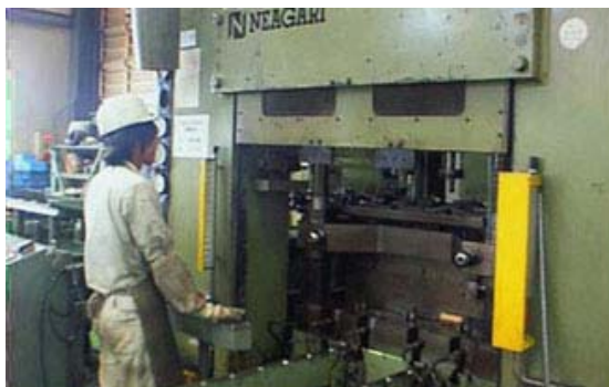
冷間鍛造プレス作業 (同社 HP)
