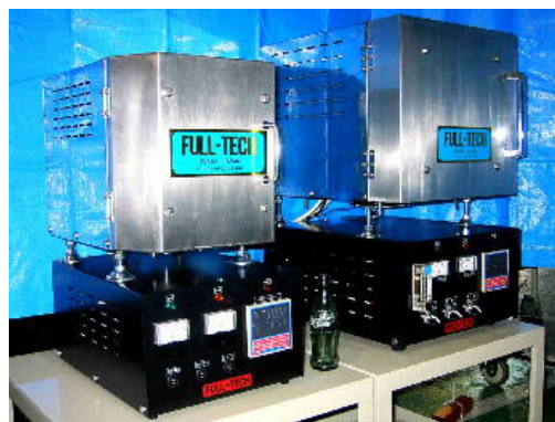
図表 4-20: 省スペース型の高温小型電気炉 (株式会社フルテック)
