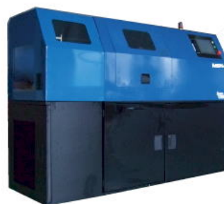
図表 4-16: モーターの耐久試験装置（株式会社スペースクリエーション）
