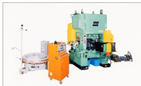
図表 4-3: 生産システムの一部例〔容器用のコンバージョンシステム〕(昭和精工株式会社)
