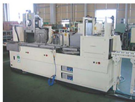
図表 4-19: 電解イオン水洗浄装置〔ハンドバッチ式〕 (高橋金属株式会社)
