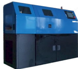
モータ性能・耐久試験装置：ハイブリッド車や電気自動車の性能評価に用いられる。
