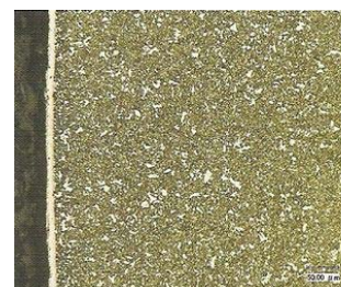
複合処理技術による被覆の断面拡大画像
