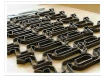
トムソン刃を用いた抜き型
