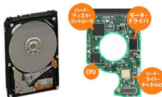
ハードディスクの内部構造 1
