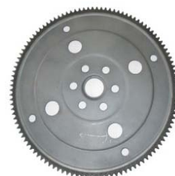
ワンピースドライブプレート 板厚 2.6mm 円板の周辺を 10mm に増肉
