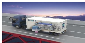
車載型小型加速器中性子源RANS-III
