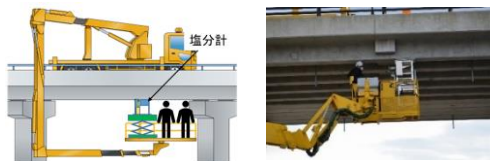
橋梁点検車に搭載可能な中性子塩分計 RANS- \mu
