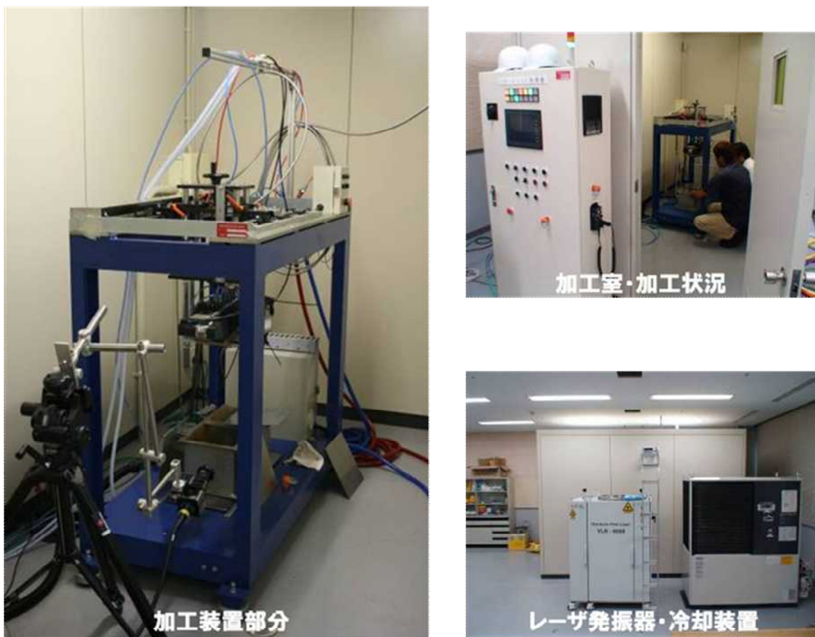
図1 . レーザ発振器、冷却装置、加工装置部分及び加工室、加工状況
