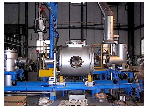
図2 小型回転炉式不純物除去装置の外観
