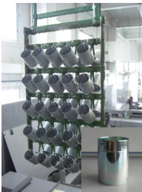
図1 プロトタイプラインでの連続運転に使用したラックとポリフェノール化成処理品(右下)
