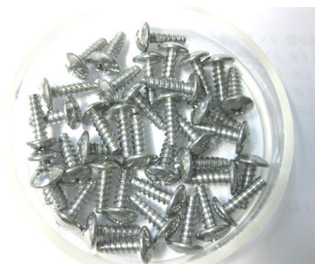
図4 環境に配慮した3価クロムバレルめっきプロセス
