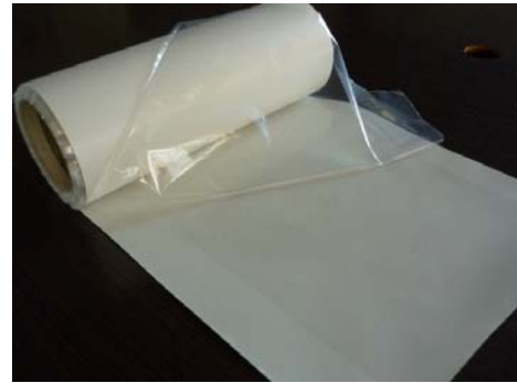
試作した薄層樹脂シート ( 150^{\circ}\text{C}\times 5 分硬化タイプ)
