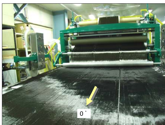
0° UD シート挿入部
