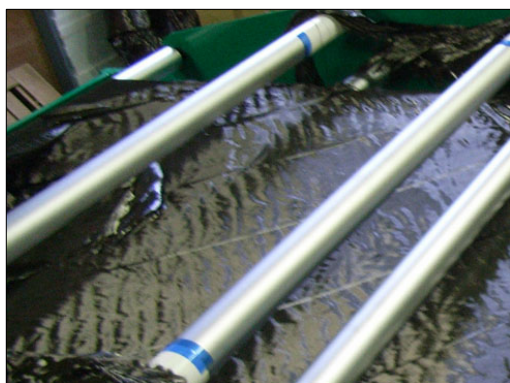
張力異常による波打ち現象
