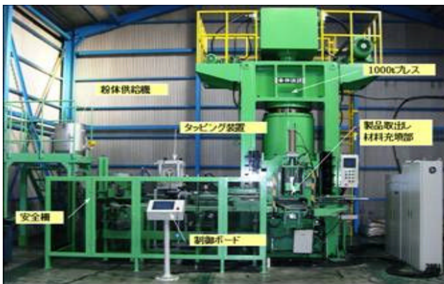
図3 1000 トンプレス装置と自動製造ライン
