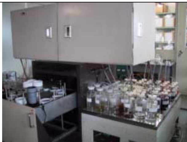
分光色彩計のデータから染料を自動調合する装置
