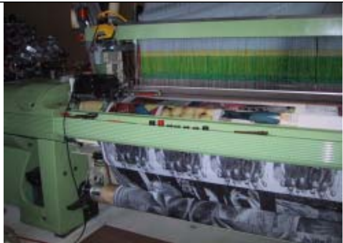
ジャガード織機により「CG データを織物」へ
