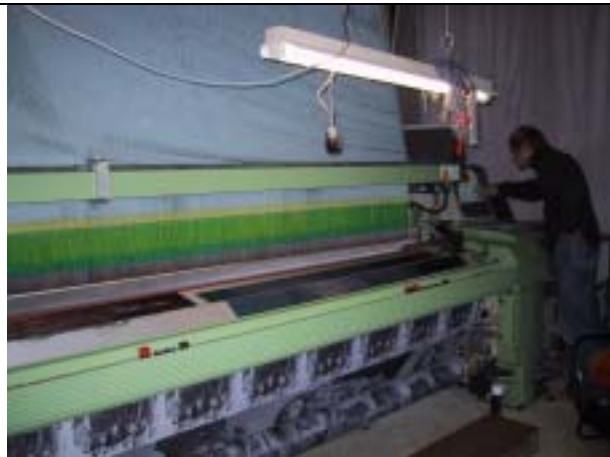
織幅 3800mm の世界最大級のジャガード織機
