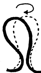
図表2-124 撚もどりトルクによる編目の傾き
