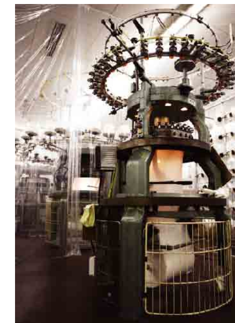
丸編み機、丸とニットにて撮影 Circular knitting machine, photographed at Maruwa Knit
