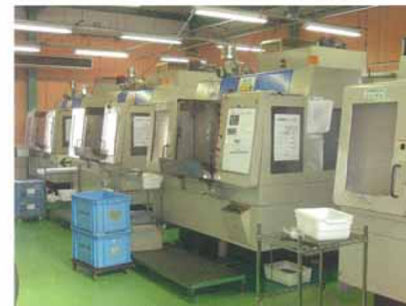
主要設備（横型マシニングセンター）
