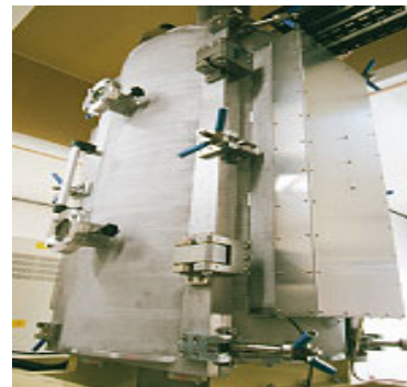
DLC 成膜用高周波プラズマ CVD 装置
