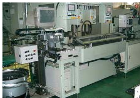
内製設備(HB ホーニング自動装置)
