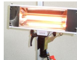
特殊ヒーターを使用した加熱装置。温度制御などに特許の技術が隠されている。
