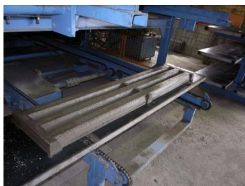
即時脱型製法で製造されたスノコ
