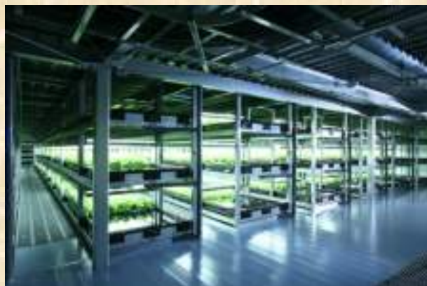
多段式完全人工光型 植物工場
