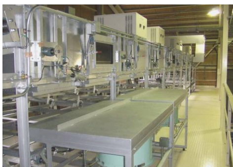
マイクロ波紙管専用乾燥機
