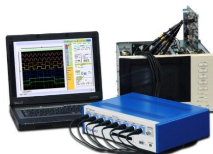
部品良否判定ツール「Signar I」 (通電状態で IC などの動作不良を診断)
