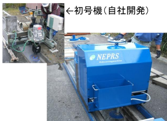
←初号機(自社開発) サイトカッティングマシン (側溝上部の破損部を水平方向に切り取る機械) 切断精度や耐久性が向上した量産機
