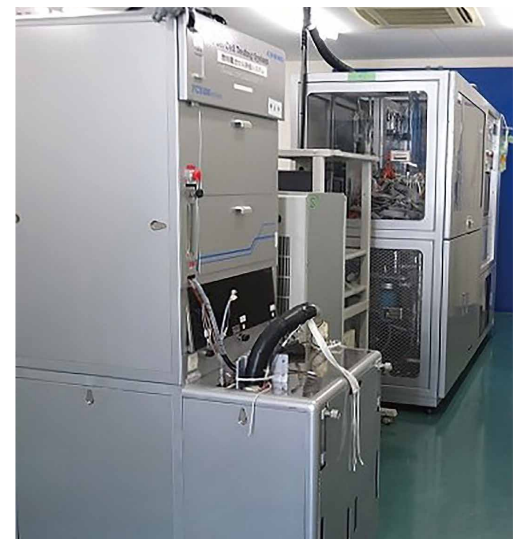
セル・スタック発電評価試験
