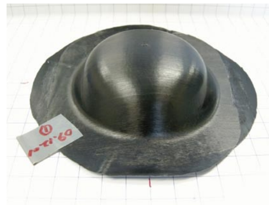
図2 熱可塑性CFRPのプレス成形品
